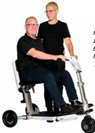
*Mit 3 Rädern ist ATTO sehr wendig und gleichzeitig sehr stabil. Mit einer Batterieladung kann bei einer Geschwindigkeit von 6 km/h eine Reichweite von 16 km erzielt werden!*
