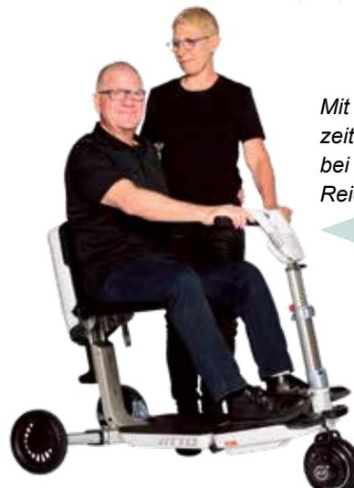
*Mit 3 Rädern ist ATTO sehr wendig und gleichzeitig sehr stabil. Mit einer Batterieladung kann bei einer Geschwindigkeit von 6 km/h eine Reichweite von 16 km erzielt werden!*
